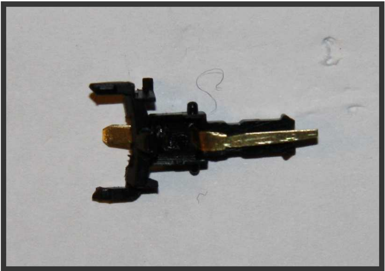
Particolare del gancio visto da sopra e primo inserimento lamella.
