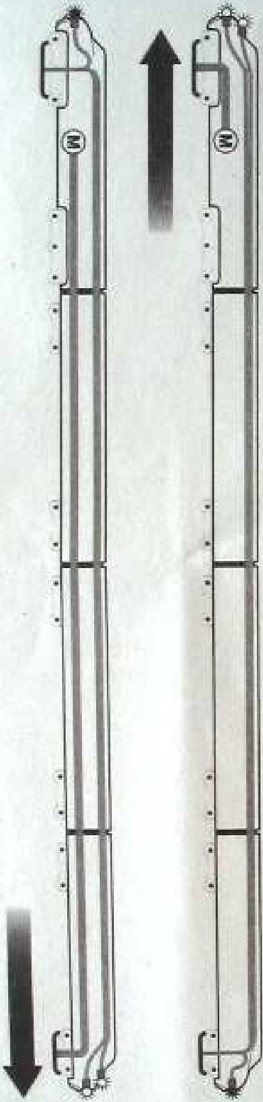
Zug kuppeln: elektrische Verbindung einstecken
