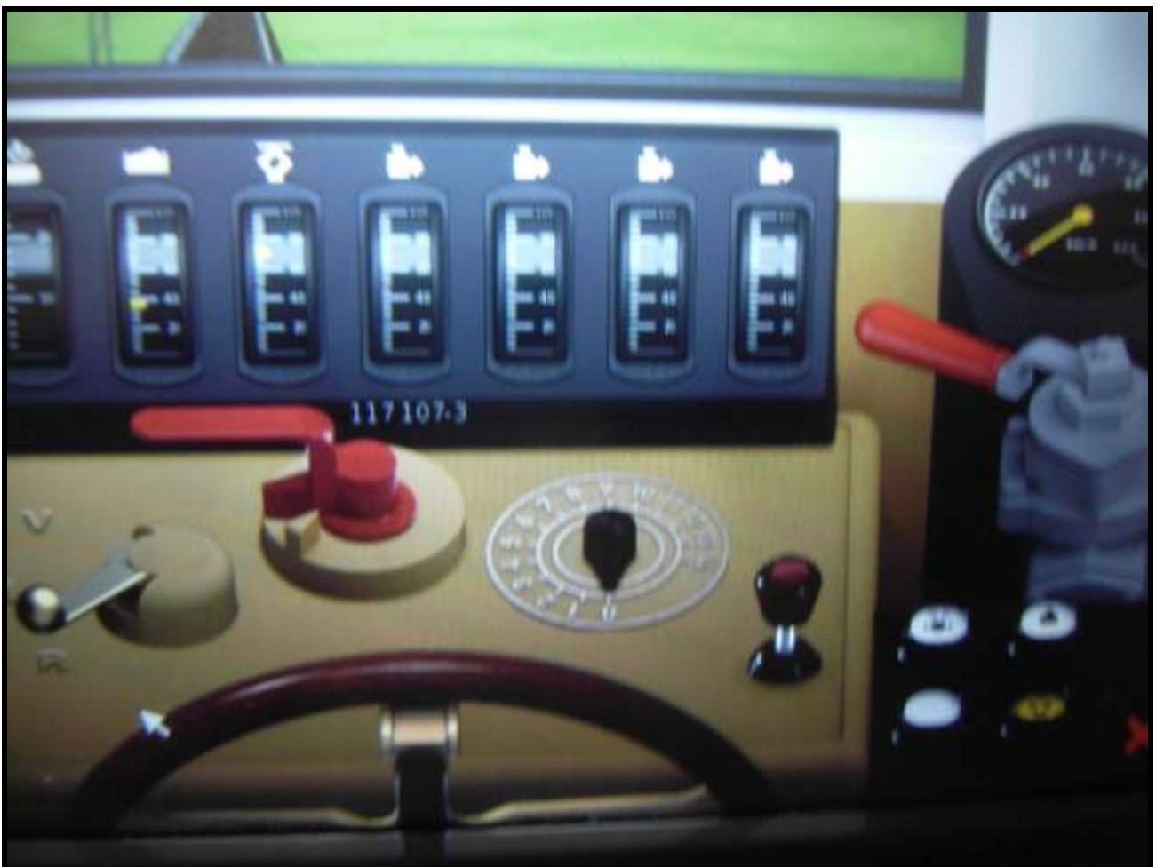
Foto n. 6: la nuova/vecchia cabina del 117 107-3 in cui il pulsante SiFa è ora posizionato sulla destra, mutate inoltre le varie strumentazioni.
