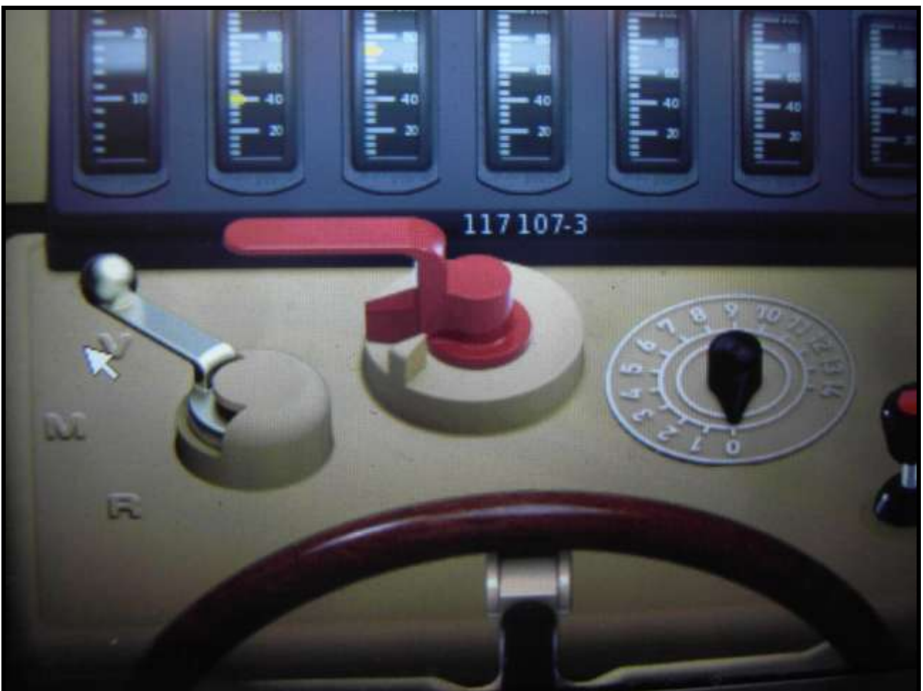
Foto n. 7: nuove leve per il 117 107-3, a sinistra l'inversione di marcia,
