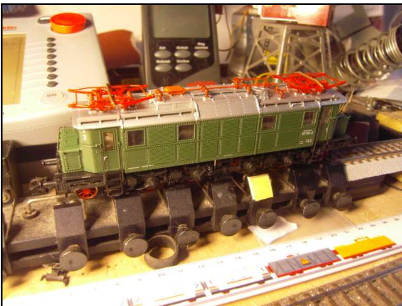
Foto n. 12: prove sul banco a rulli della nuova 117 107-3 .
