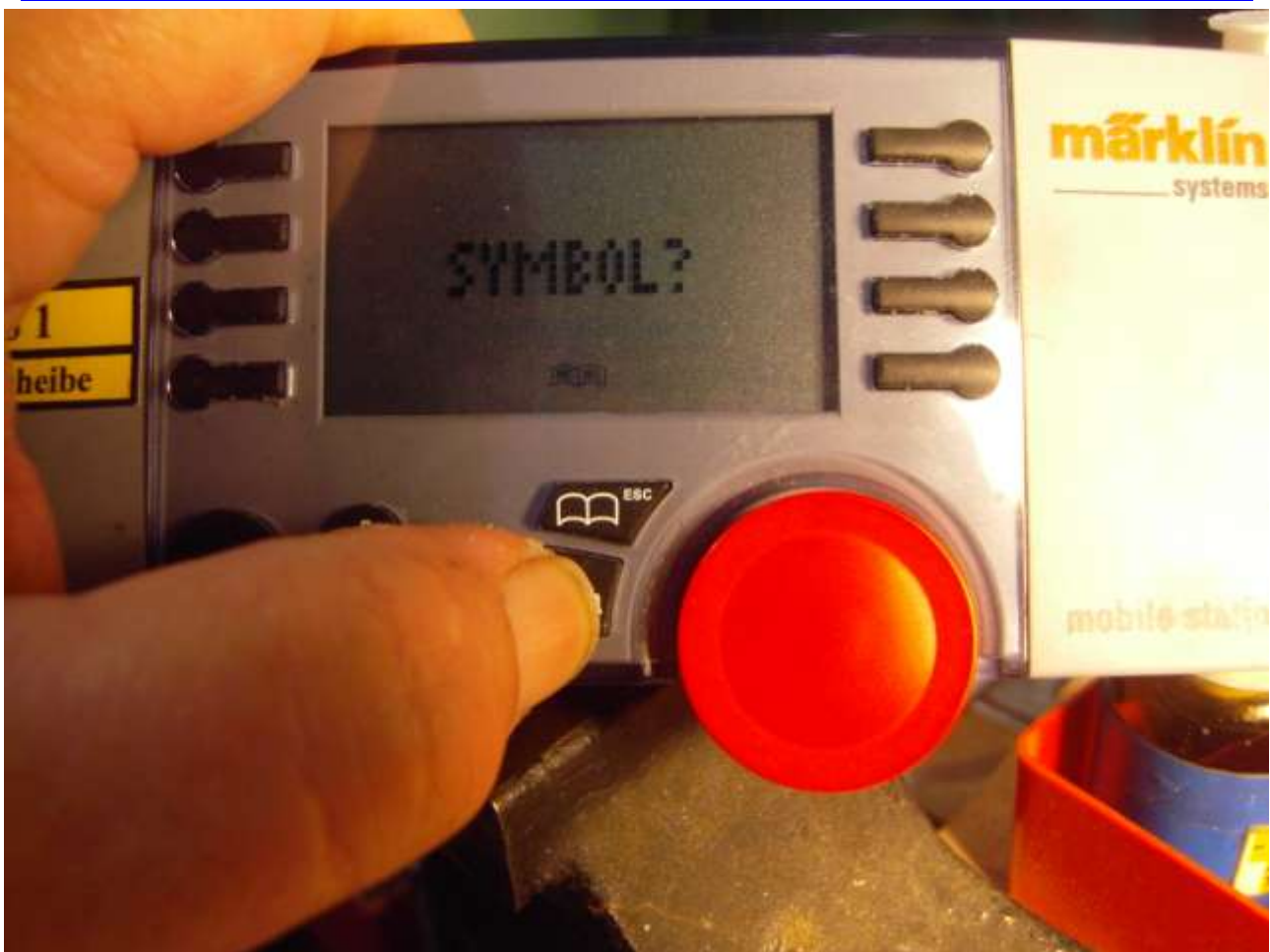
Foto n. 15: mentre lampeggia SYMBOL si spinge il pulsante OK, così appare il simbolo che si vuole nel codice 60.
