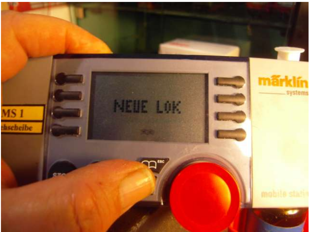
Foto n. 2: da NEUE LOK si spinge il pulsante OK.
