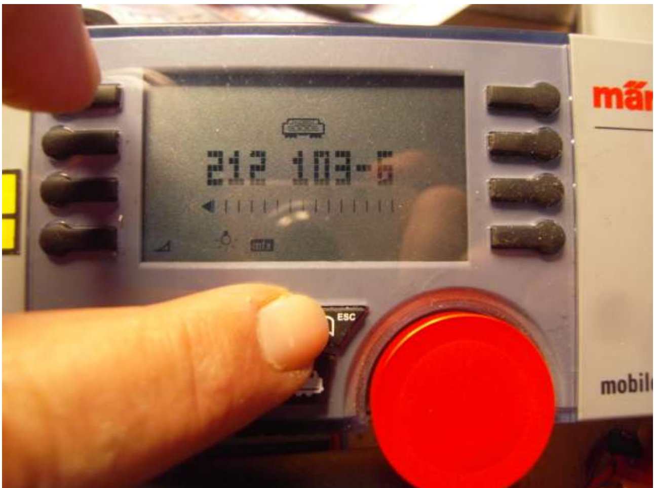
Foto n. 1, operazione preliminare: si spinge il pulsante ESC.
