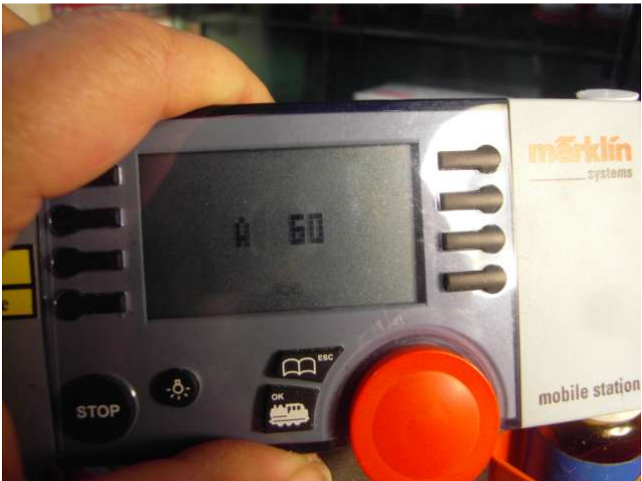
Foto n. 9: girando in senso orario si va per esempio al codice 60 Motorola, che ci serve in questo esempio.
