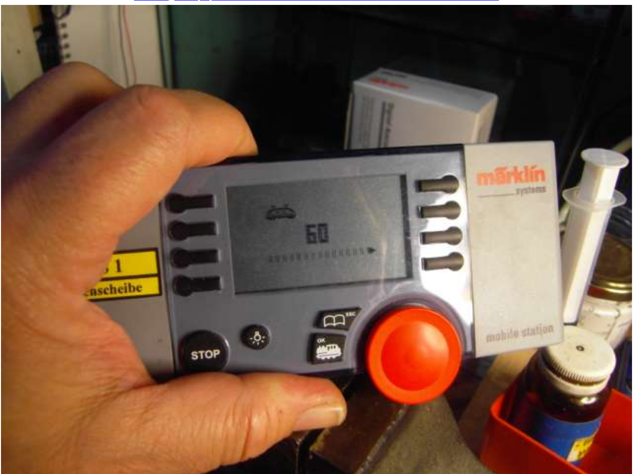
Foto n. 17: spingendo OK si entra nel codice 60 e termina il lampeggio.
