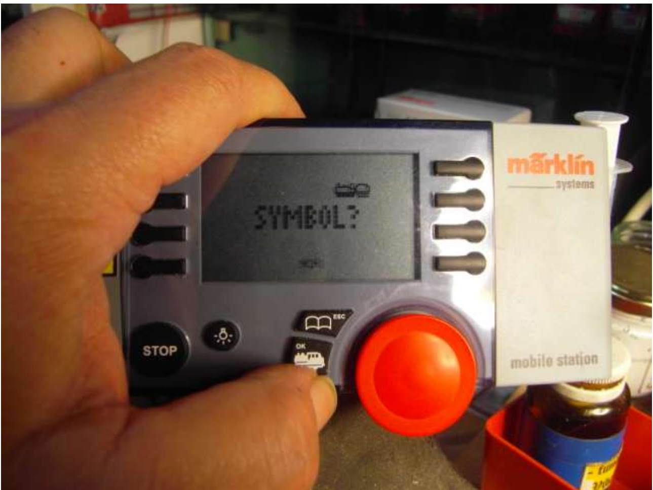
Foto n. 11: spinto OK appare, lampeggiante, la scritta SYMBOL?, se si vuole, si può modificare il simbolo manovrando con la manopola.
