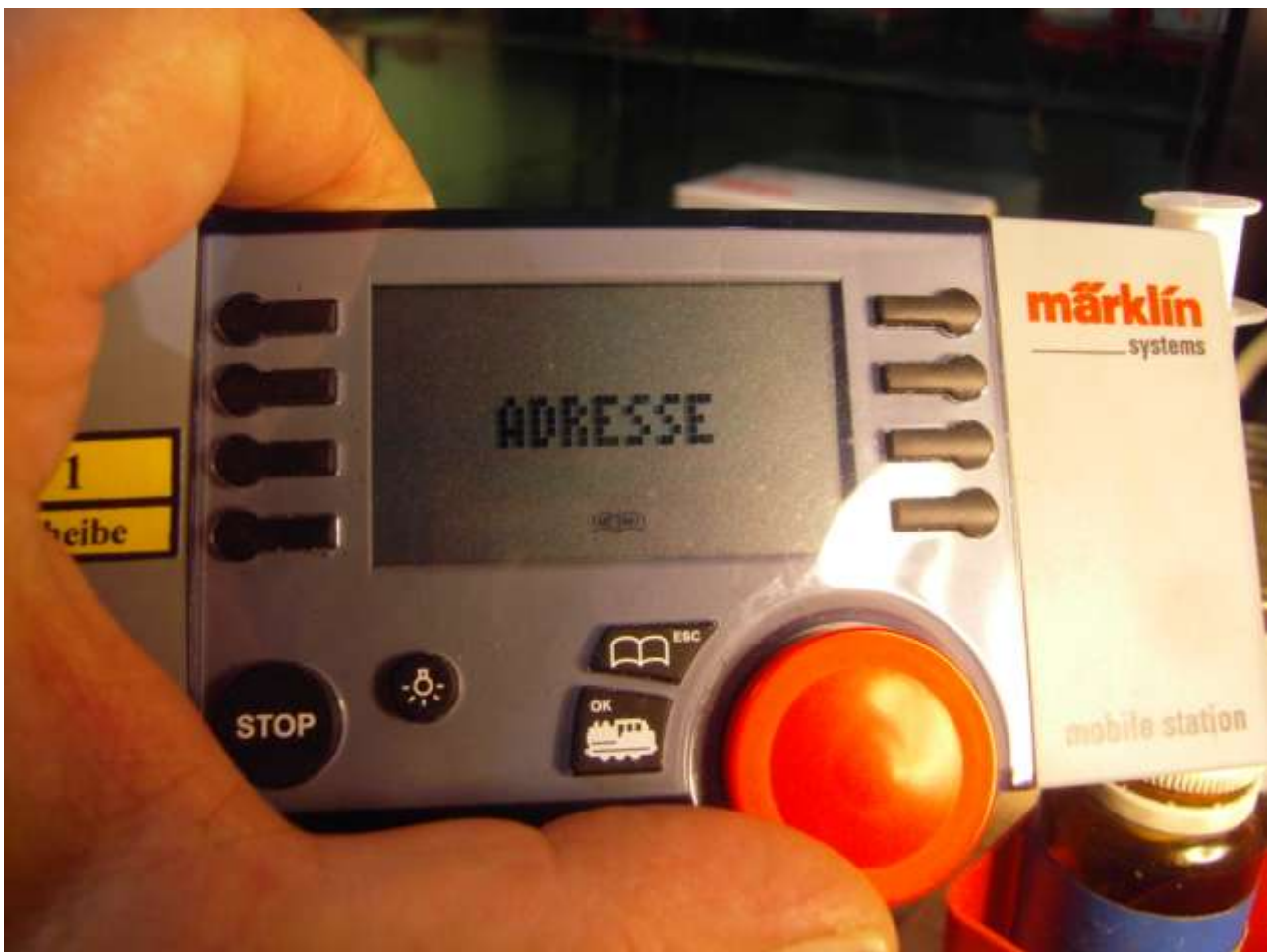
Foto n. 4: manovrando in senso orario si trova ADRESSE, indirizzo.
