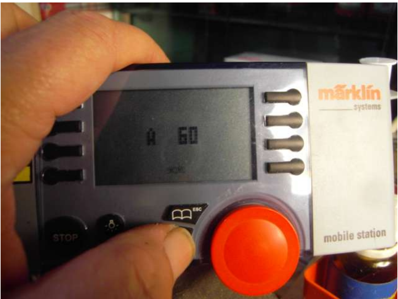
Foto n. 10: si spinge allora il pulsante OK e si entra nel codice 60.
