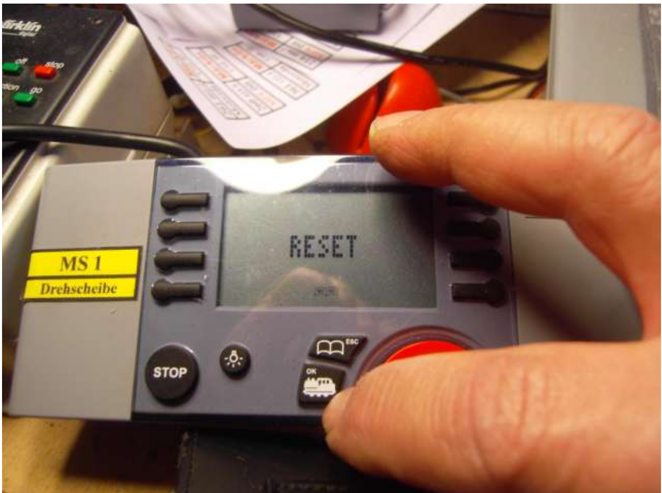
Foto n. 17: girando la manopola in senso orario compare poi RESET.
