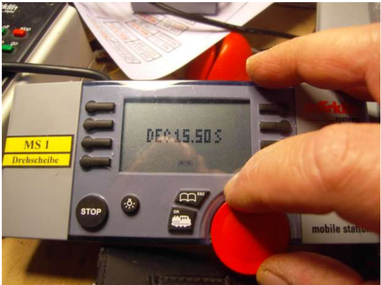
Foto n. 14: girando la manopola in senso antiorario si diminuisce il ritardo sino a portarlo praticamente a zero (come una loco analogica).
