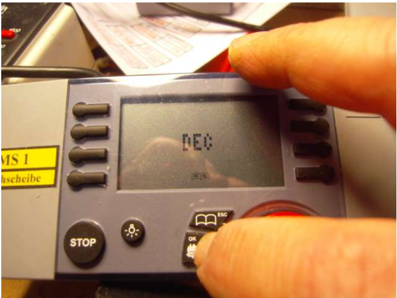
Foto n. 12: se, per esempio, si vuole cambiare il ritardo di decelerazione nella loco si spinge il pulsante OK.
