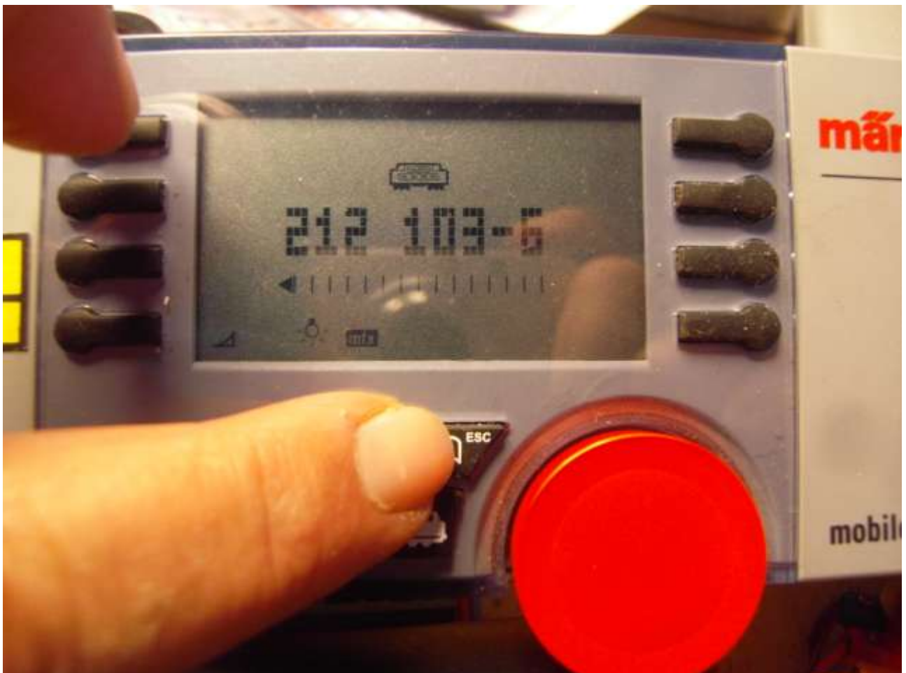
Foto n. 3: per entrare nelle programmazione si spinge il pulsante ESC.
