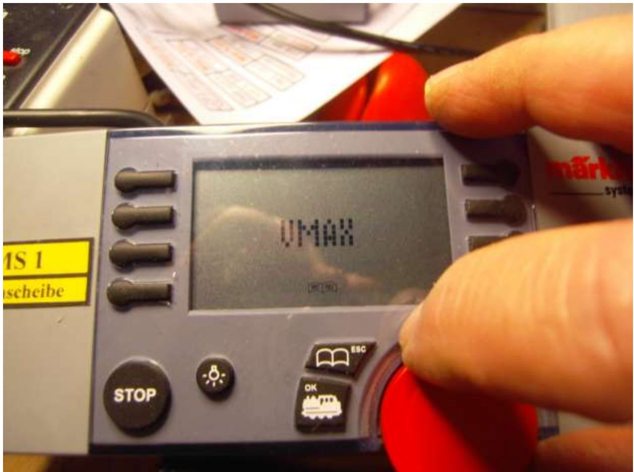
Foto n. 9: compare VMAX (se non si vuole cambiare la velocità massima della loco si gira ancora a destra la manopola rossa).
