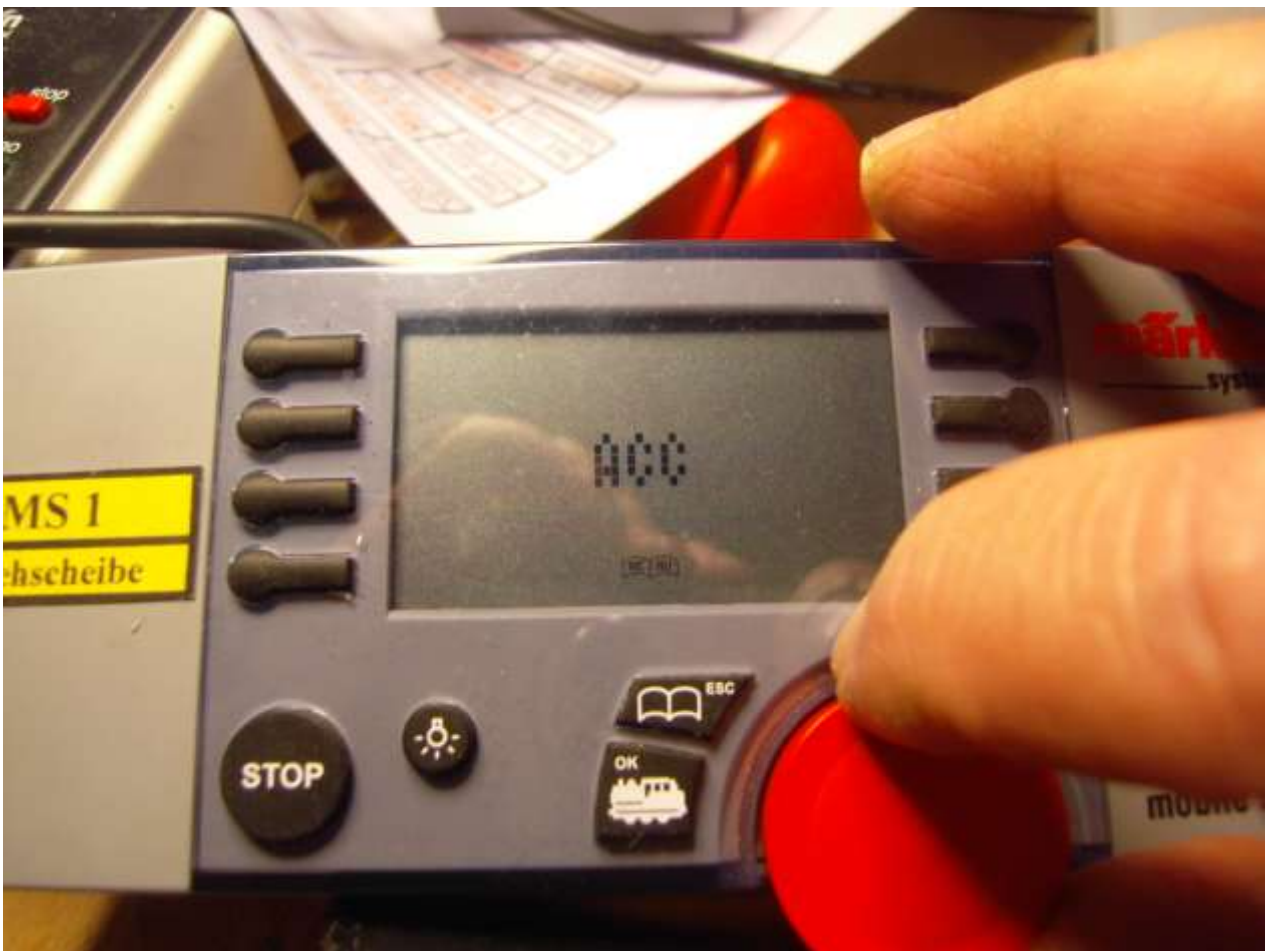
Foto n. 10: compare ACC (se non si vuole cambiare il ritardo di accelerazione nella loco si gira ancora a destra la manopola rossa).
