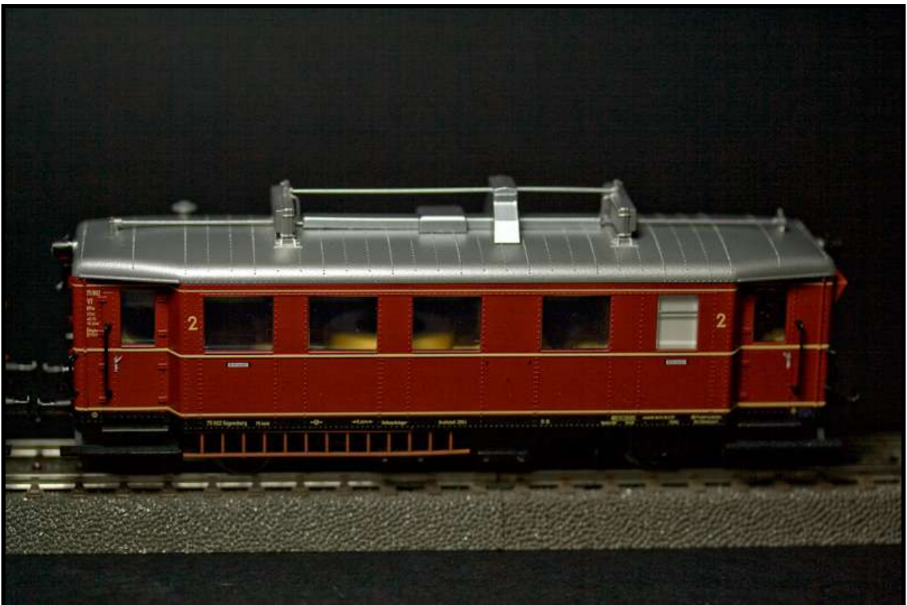
Foto n. 9: l'imperiale del VT 75, cavi troppo generosi.
