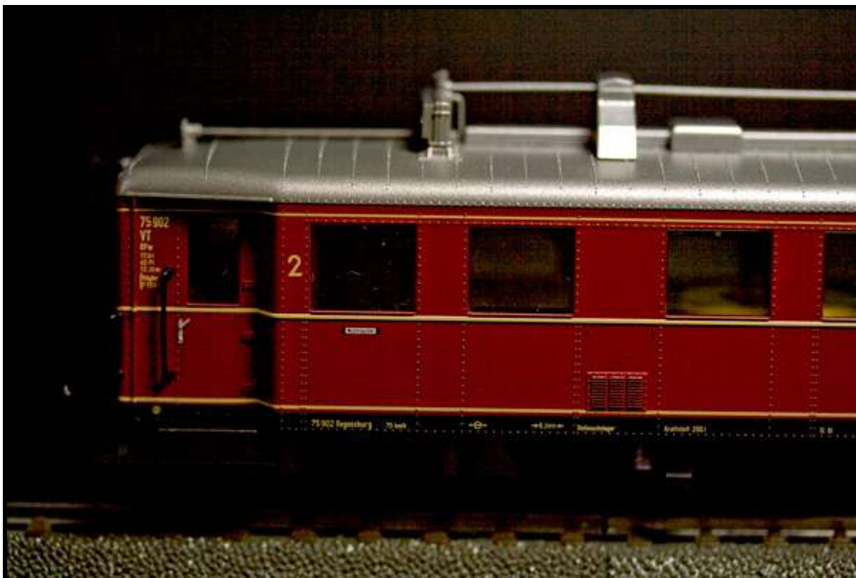
Foto n. 15: il VT 75, particolari delle chiodature.
