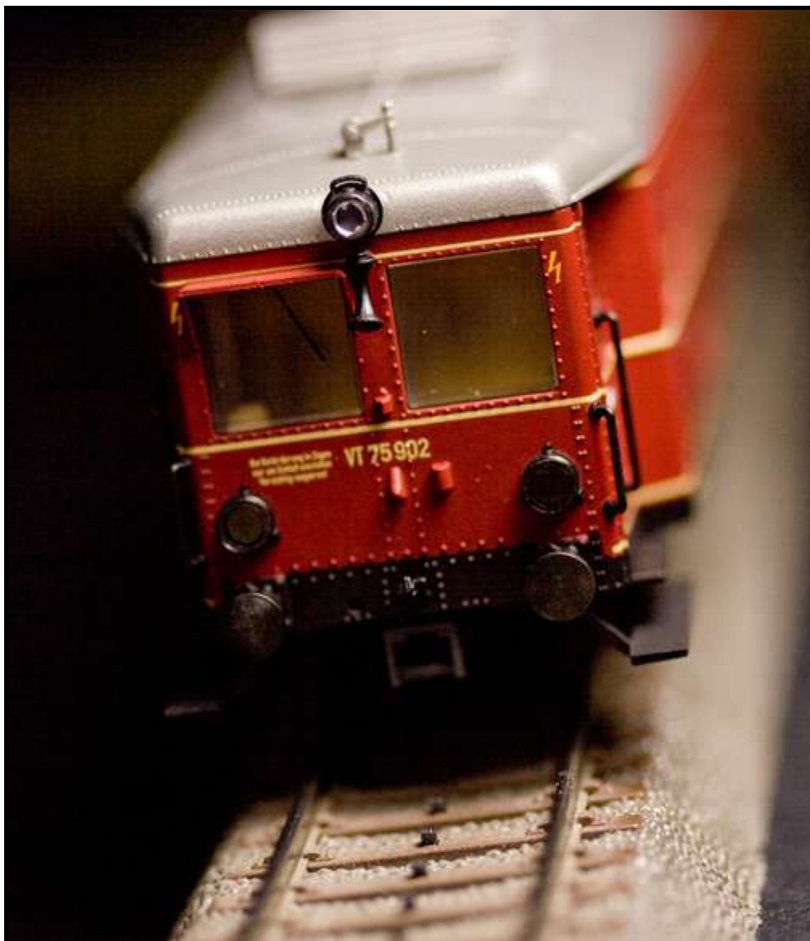
Foto n. 10: i corrimani anteriori del VT 75 troppo robusti, la leva del fischio troppo simile al colore del tetto.
